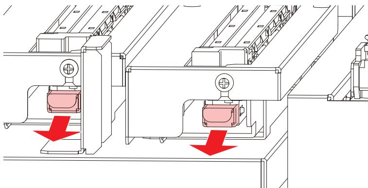
**4 NCUインク受けからNCUインク吸収材を外す。**
