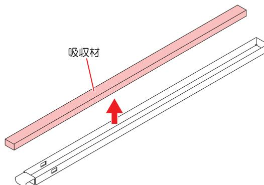
**5 NCUインク受けを清掃する。****6 新しいNCUインク吸収材をセットする。****7 NCUインク受けをセットする。**
