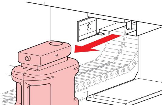
**5** 取り外した廃インクタンクにキャップをはめて、テープなどを使用して廃インクが漏れないように処理する。
